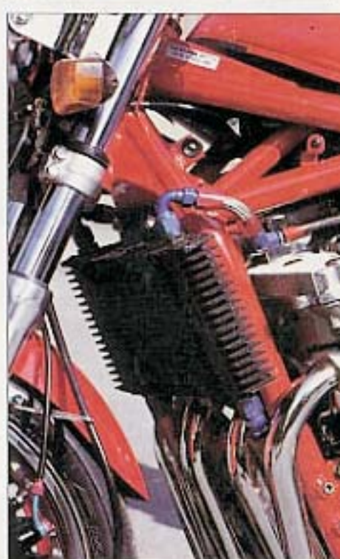
In alto, primo piano del terminale di scarico, di forma ovale e dotato di due uscite. Il forcellone è quello di una GSX-R dell'88. Un secondo radiatore (sopra) affiancato a quello di serie, è stato interposto sulla mandata olio di raffreddamento alla testa.
