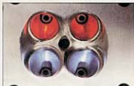
Nelle foto qui sopra, l'accoppiamento collettore/condotto di aspirazione con viti coniche e un primo piano del lavoro eseguito sulle sedi valvole.
